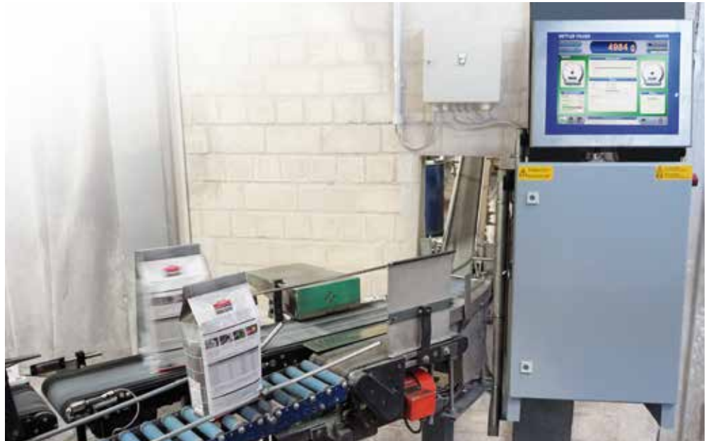
Pesatura di sacchi stand-up con un sistema di controllo peso XS40
